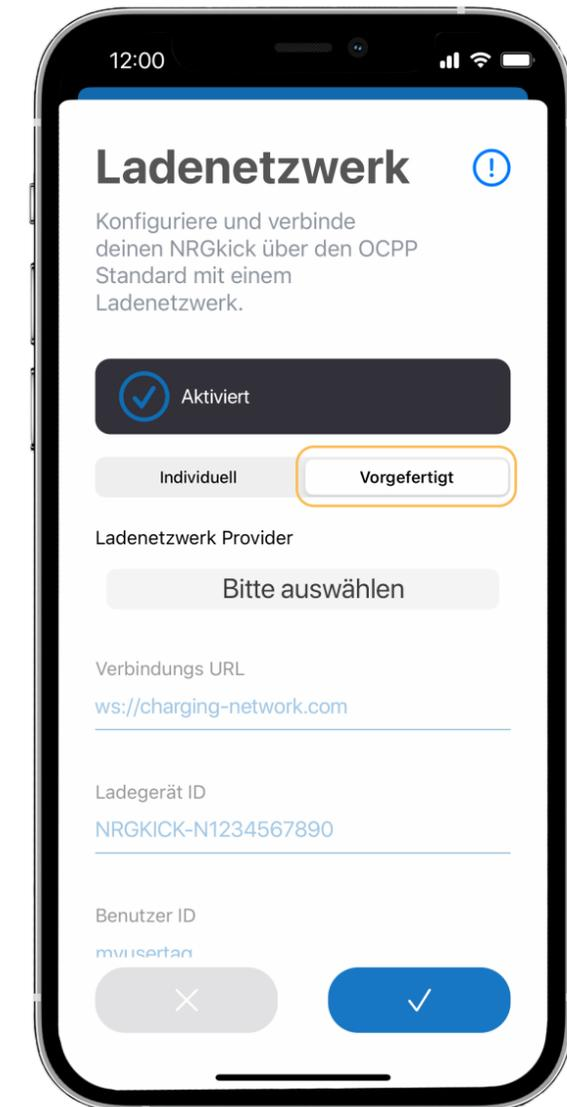
**9.2.** Sofern der Ladenetzwerk-Partner fest eingebunden ist, wählen Sie „Vorgefertigt“ aus. Verbindungs URL und Ladegerät ID werden in diesem Fall vorausgefüllt (aus Bestandteilen der NRGkick-Seriennummer).
